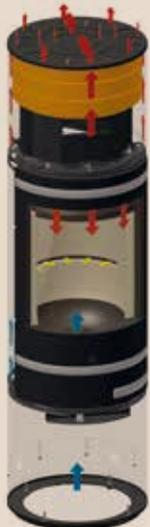
Une commande située en haut de l'appareil permet de faire le choix entre un chauffage par convection ou par rayonnement. Allumez votre feu avec la commande ouverte pour un chauffage rapide par convection. En position fermée, la chaleur sera accumulée pour une restitution 12 heures durant.
