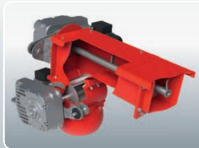
Le clapet coupe-feu garantit l'étanchéité entre la chaudière et le système d'extraction de combustible. Le système avec écluse rotative coupe-feu est recommandé pour les silos potentiellement en dépression (ex : menuiserie dont le silo est alimenté par le système d'aspiration de copeaux).
