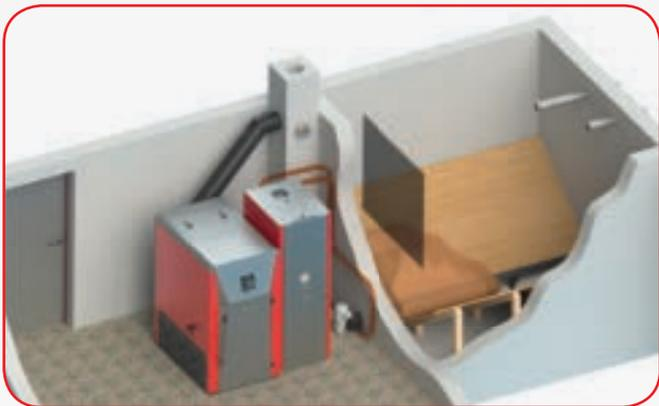
Les granulés peuvent être stockés dans une pièce de réserve équipée de pans inclinés et d'une vis de désilage en fond de silo. Un large choix de longueurs de vis est disponible.
