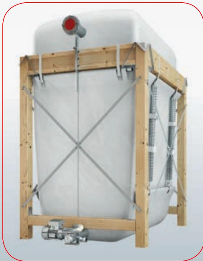
L'autre solution consiste à stocker les granulés dans un silo textile. Ces silos sont également équipés d'une vis de désilage en fond de silo mais disposent en plus de tendeurs de toile permettant d'augmenter le volume de stockage.
