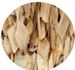
Bois déchiqueté avec une granulométrie maximale G30 G50 et une humidité maximale de 35 % correspondant à la norme autrichienne ÖNORM M7133, granulés de bois diamètre 6 ou 8 mm.
