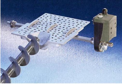
Insensible aux corps étrangers grâce à l'introduction latérale du combustible. La grille bascule de 90°C – Elimination automatique des cendres, mâchefers.
