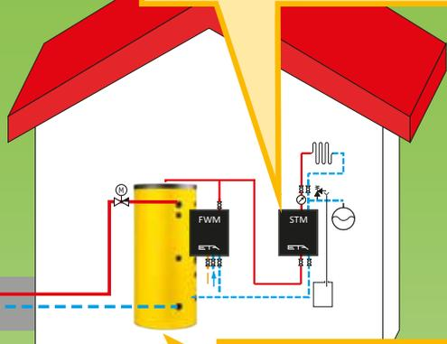
L'eau chaude sanitaire est ainsi préparée économiquement, instantanément et rapidement avec l'**accumulateur ETA ECO** et l'**échangeur ECS ETA**.
